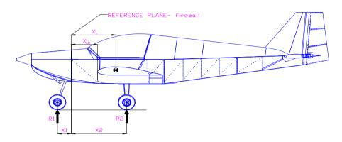
L'avion est pesé sur ses roues – toutes les roues doivent êtres de dimensions correctes et parfaitement gonflées. Dans ce cas l'avion est en bonne position pour determiner le centre de gravité. Le plan de référence est déterminé par la paroi pare feu. Tous les liquides doivent êtres remplis au volume maximum et il ne doit rester que le carburant inutilisable dans le système. Pour simplifier la collecte des information, les valeurs suivantes doivent être mesurées
